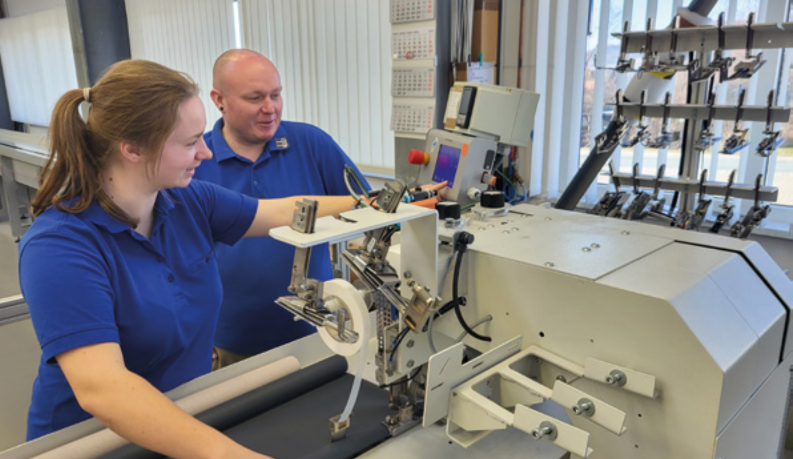
Zwei erfahrene Mitarbeiter (ehemalige Azubis) an einem hochmodernen Ultraschall-Klebe-Schweißautomat.
